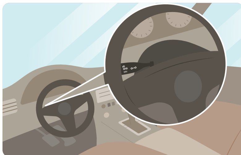
閃爍汽車大燈（方向盤後方有一個搖桿，做前後撥動，就可以閃爍車燈）
